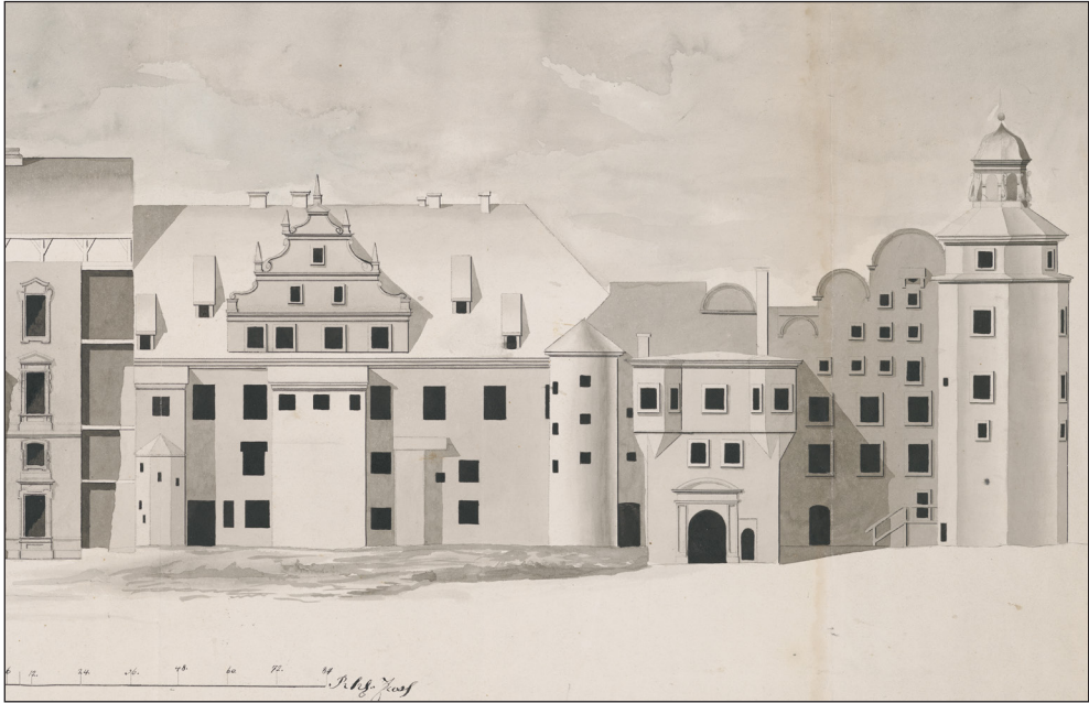
Abb. 4. Der Ostflügel von Osten gesehen, rechts der Haberturm, daneben der Giebel des Kornhauses, dann das Albrechtstor mit den beiden Eckerkern – die einst steilen Dächer sind verschwunden –, dahinter die einstige Burgmauer mit dem stehengebliebenen Segmentgiebel des Tordaches; links davon der Wendeltreppenturm und der nördliche Teil des Ostflügels mit einigen in den einstigen Zwinger vorspringenden Vorbauten, in denen Aborte lagen; die Zwinger vor dem gesamten Ostflügel wurden vor der Krönung 1701 zugeschüttet; ganz links beginnt der neue Barockflügel; lavierte Zeichnung von Joachim Ludwig Schultheiss von Unfriedt, 1712; GStA PK, XX. HA, Allgemeine Kartensammlung, F 10.562 (Ausschnitt).
